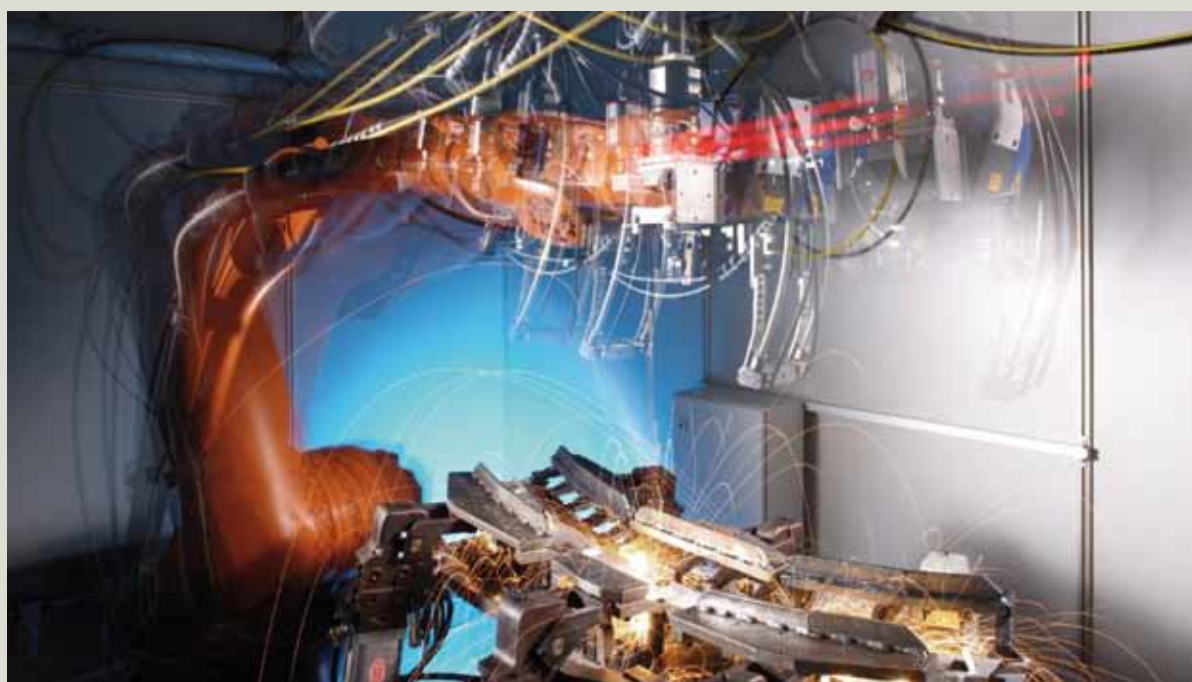
Remote-Schweißen mit einem Scheibenlaser © Bayerisches Laserzentrum/Fuchs
